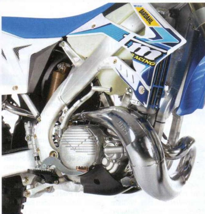
Dabei setzt man primär auf Keihin-Komponenten, die in einem eigenen Drosselklappengehäuse integriert wurden. Die Einspritzung erfolgt hinter den Überströmkanälen.
