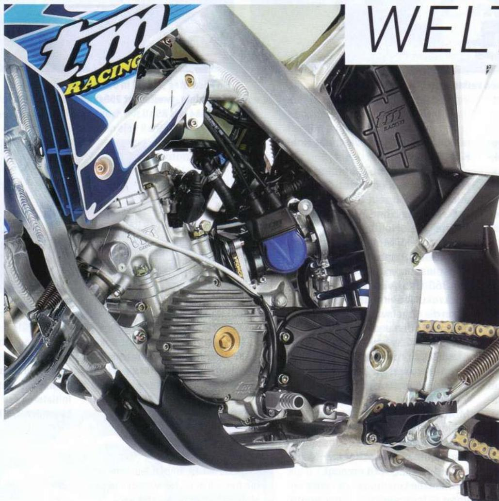
Der V-Force-Membranblock gehört ebenso dazu wie die automatische Ölzufuhr, zwei wählbare Zündkurven, die hydraulisch betätigte Kupplung und das Sechsgang-Getriebe. Wie auch in den Vorjahren bleibt man dem Leichtmetall-Rahmen treu und setzt zudem auf die bestens bewährte 48er Kayaba-Gabel und ein TM-Federbein. Die 270 Millimeter große Vorderrad-Wave-Bremsscheibe ist Standard wie auch der Scheinwerfer und die Blinker mit LED-Technik.
